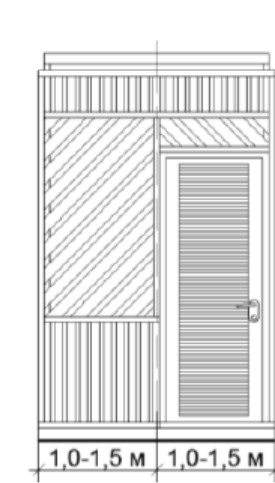
торцевой фасад с дверью
